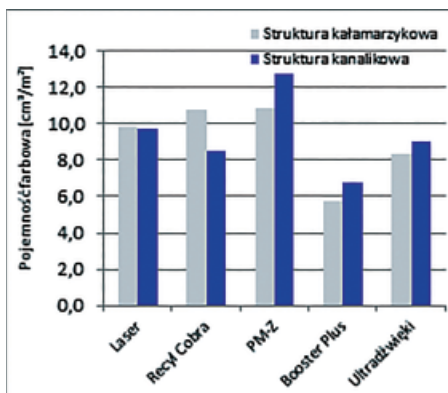
Rys. 1. Porównanie pojemności farbowej wałka pokrytego farbą wodną po czyszczeniu (pomiar metodą wolumetryczną)
